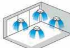
Installazione in grande spazio
