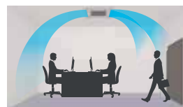
Distribuzione omogenea dell'aria con l'attivazione dell'effetto swing.
