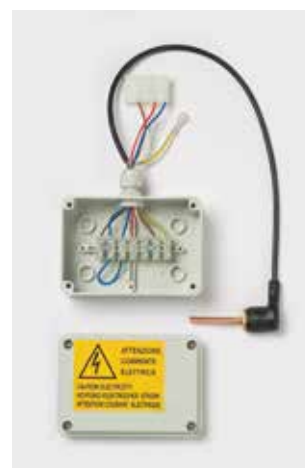
AFS/MRS6-32 o 42: Morsettiera 5 poli - IP55 con termostato temperatura acqua calda - 32°C oppure 42°C
