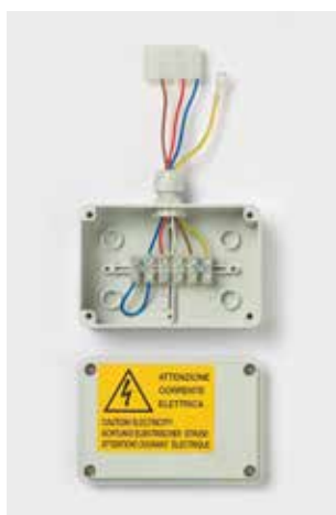
AFS/MRS2-32 o 42: Morsettiera 5 poli - IP20 con termostato temperatura acqua calda - 32°C oppure 42°C
