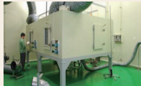
اختبار المسعر الحراري Calorimeter testing
